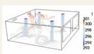
流跡線(K)のシミュレーションおよび可視化
